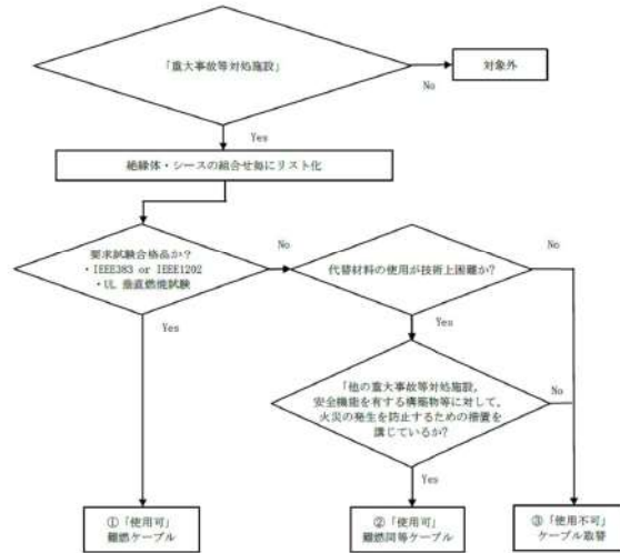
第1図：難燃性ケーブル確認方法
