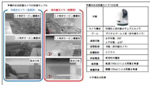
図2-3 構内状況把握カメラの概要
