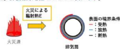
第2.3.2.3-2図 排気筒の評価概念図
