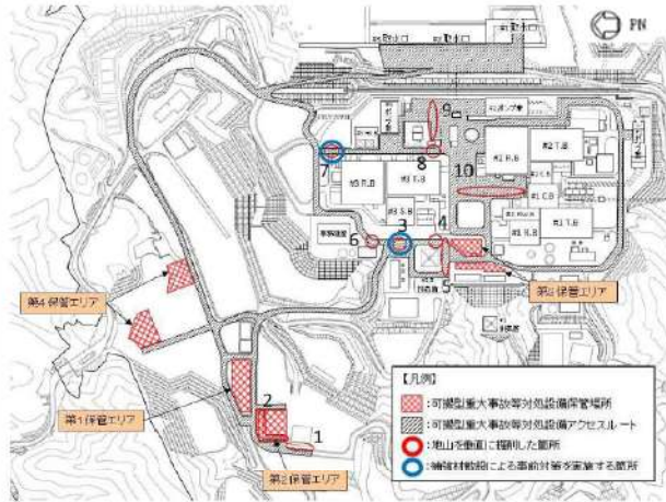
第6-25図 地山を垂直に掘削した箇所の抽出箇所
