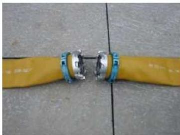
可搬型ホース (150A) 接続前
