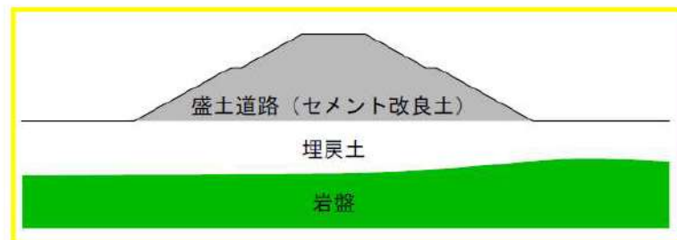
第6-29図 C-C' 概略断面図
