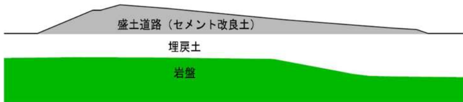
第6-28図 B-B' 概略断面図
