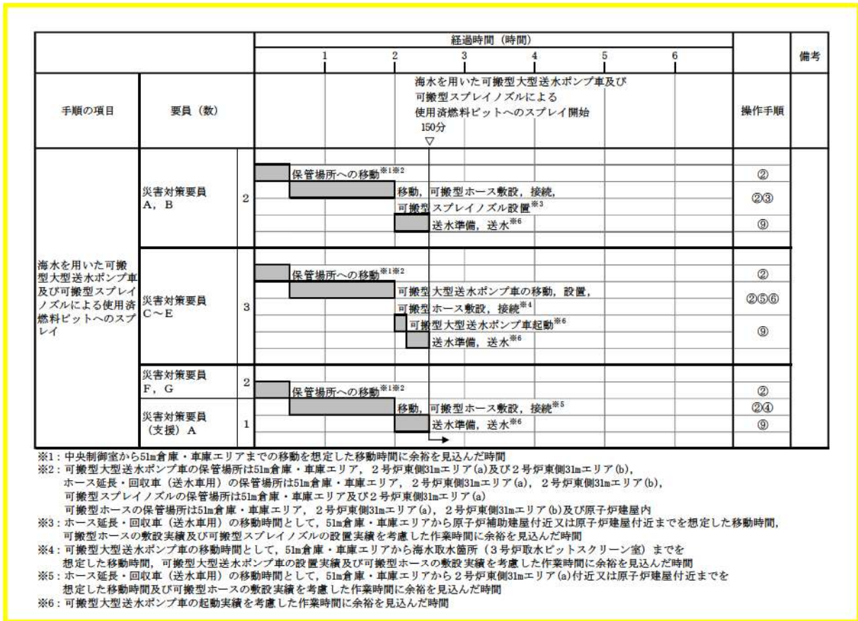
図 2.11-4 海水を用いた可搬型大型送水ポンプ車及び可搬型スプレイノズルによる使用済燃料ピットへのスプレイ タイムチャート ※
