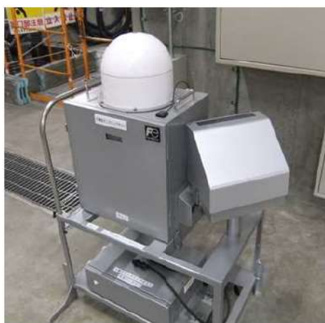
第2-23図 可搬型モニタリングポスト（設置イメージ）
