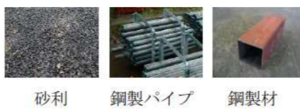
図1 泊発電所の設計飛来物 (イメージ)
