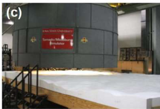
第 3-1 図 風洞実験の様子 (Karstens 2012)
