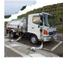
可搬型タンクローリー
