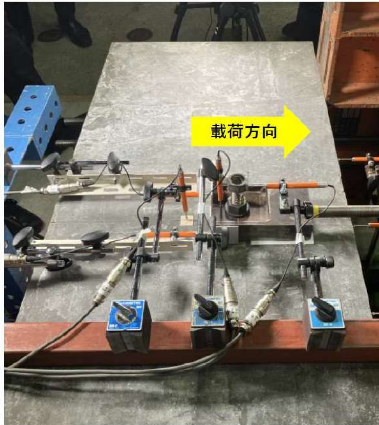
第 7-66 図 せん断試験最大荷重载荷後の状況写真 (破壊形式確認ケース)
