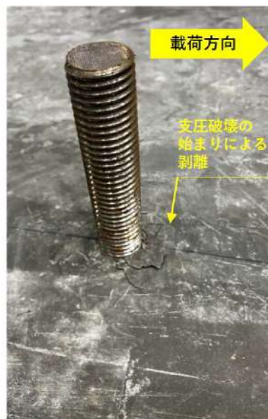
第 7-67 図 せん断試験後の状況写真 (破壊形式確認ケース)
