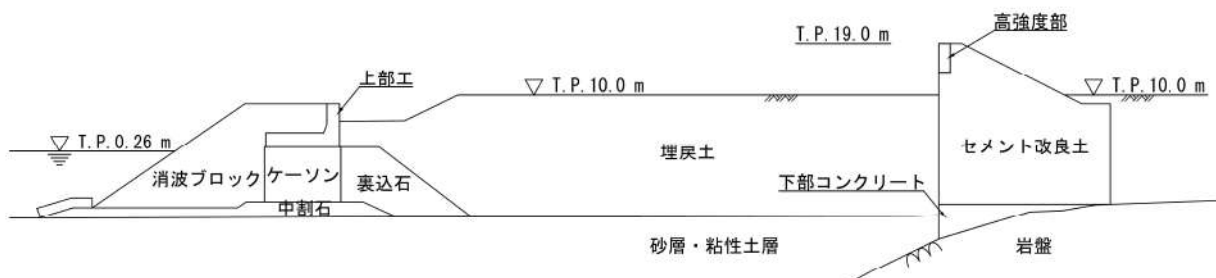
第 5-5 図 防潮堤（標準部）の横断図
