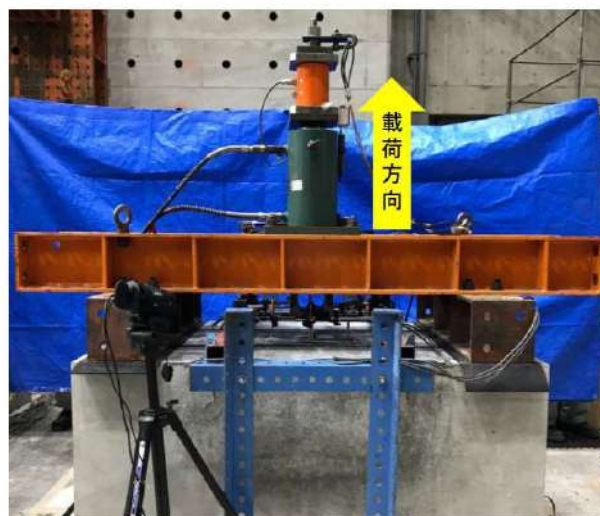
第 7-52 図 引張試験イメージ写真
