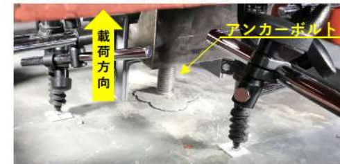
引張試験最大荷重載荷時の状況写真※2
