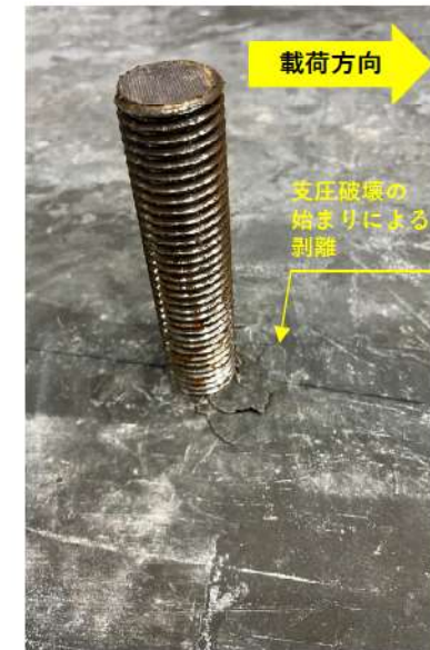
せん断試験後の状況写真
