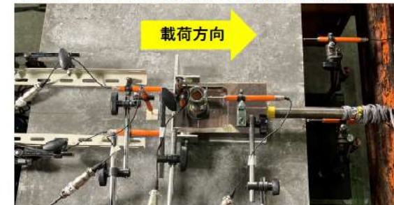
せん断試験最大荷重載荷後の状況写真
