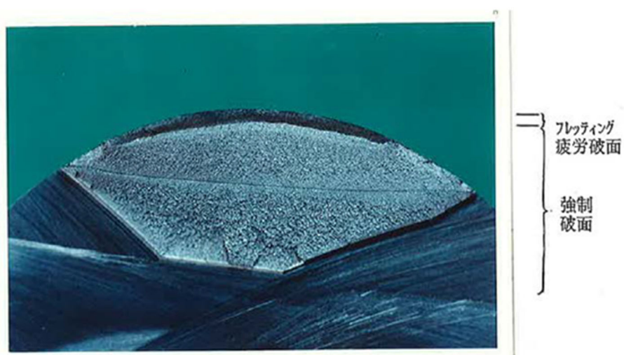
図7 フレット疲労破面例
