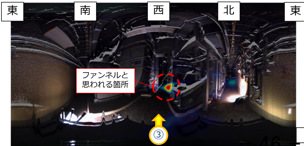
測定箇所③におけるγカメラ測定結果 (オーバーレイ画像)
