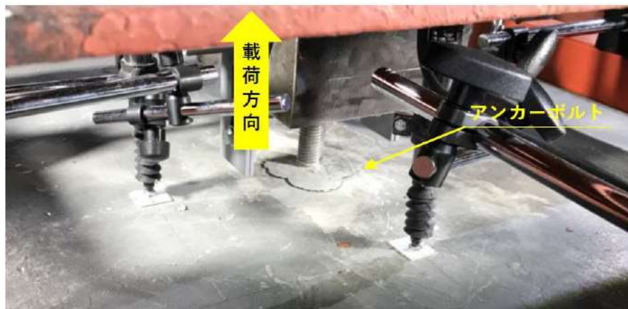
第 7-58 図 引張試験1-4 最大荷重載荷時の状況写真
