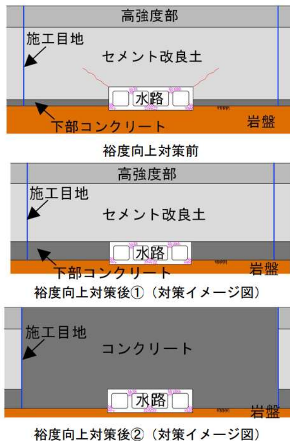
第 5-44 図 取水路及び放水路が横断する範囲の防潮堤の裕度向上対策のイメージ図
