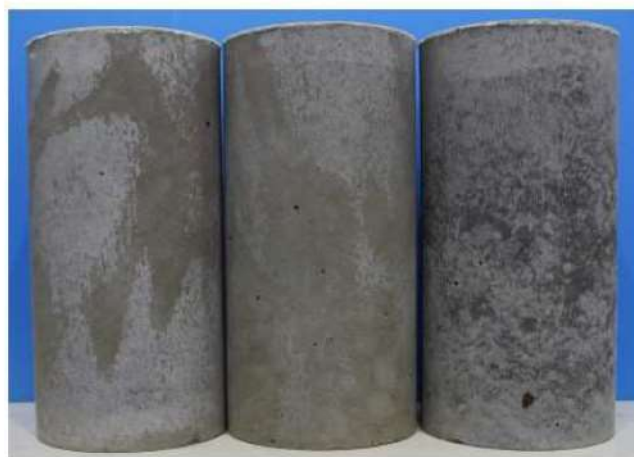
第 7-46 図 セメント改良土の室内試験用供試体 ( \phi 150\text{mm} , H300mm)
