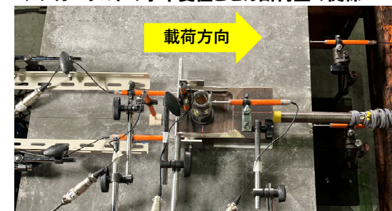
せん断試験最大荷重載荷後の状況写真
