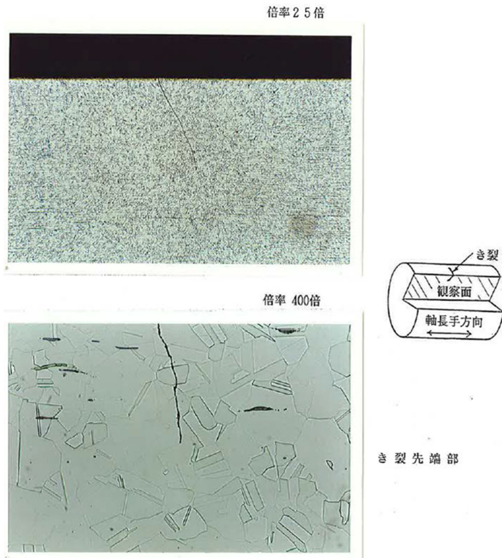
図8 フレッシング疲労き裂の断面マイクロ観察例
