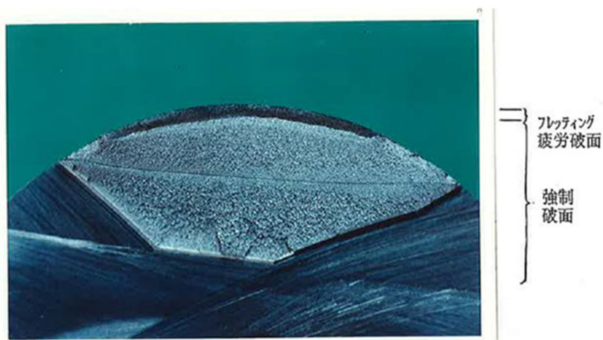
図7 フレット疲労破面例
