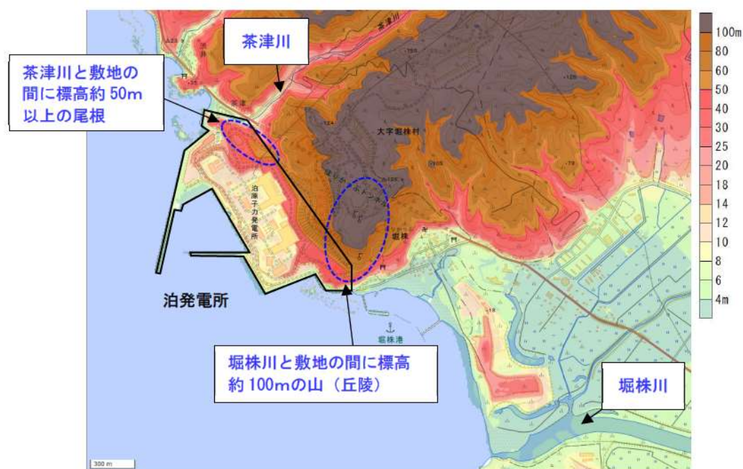
図 1.1.c.b-1 遡上波の河川・水路を經由した敷地への到達可能性の評価結果※
