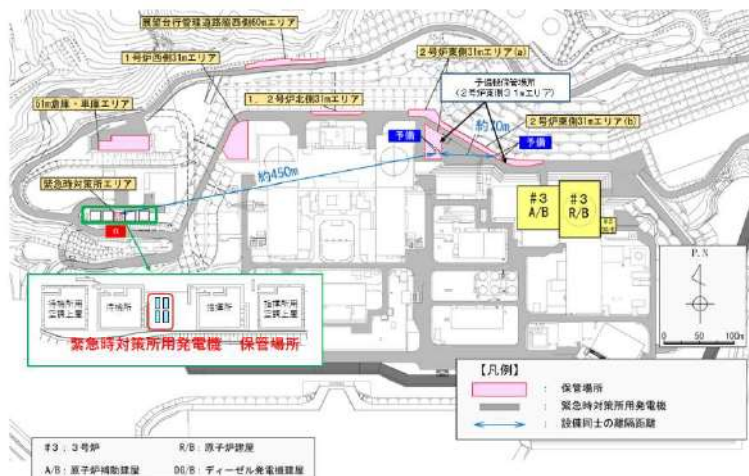
図4-10 緊急時対策所用発電機の保管場所
