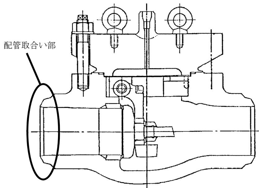
図1 蓄圧タンク出口第2逆止弁の構造図
