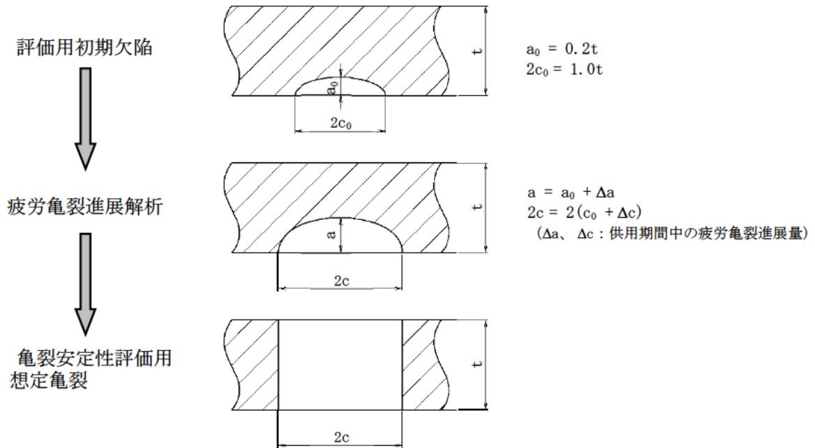
図6 想定亀裂置換えイメージ
