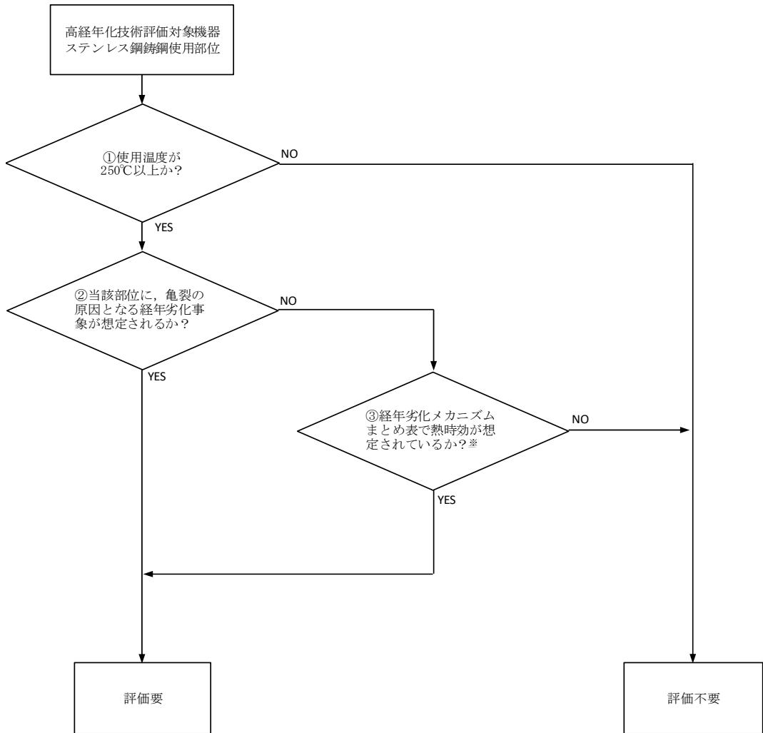
※日本原子力学会 原子力発電所の高経年化対策実施基準の経年劣化メカニズムまとめ表に想定される経年劣化事象として熱時効の記載がある場合でも、高経年化技術評価不要の条件を満たしている場合は、評価不要と判断する。
