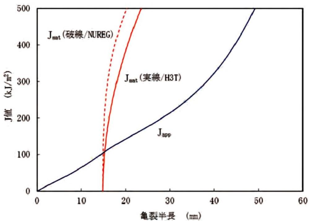
図4 蓄圧タンク注入ライン管台
