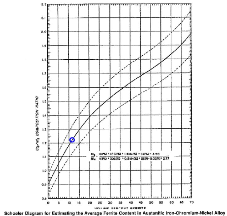
図1 フェライト量導出図 ASTM A800 参照
