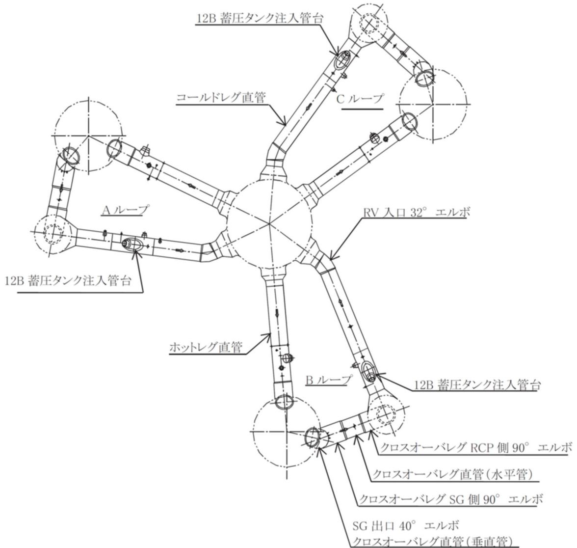
図 3 1 次冷却材管の熱時効評価対象部位
