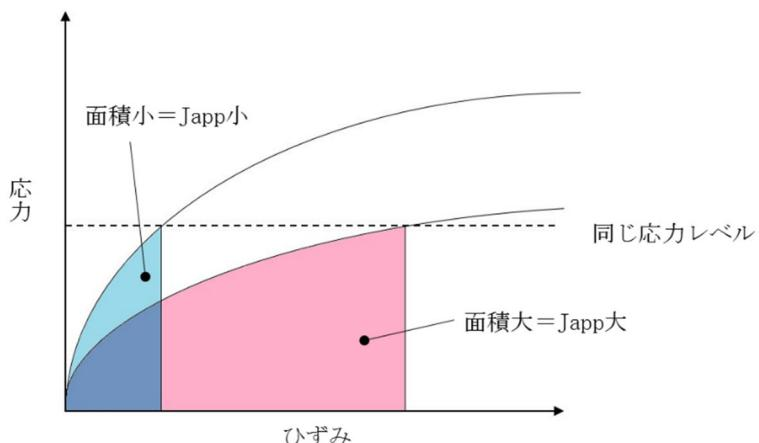
図 1 応力ーひずみ関係と Japp (模式図)
