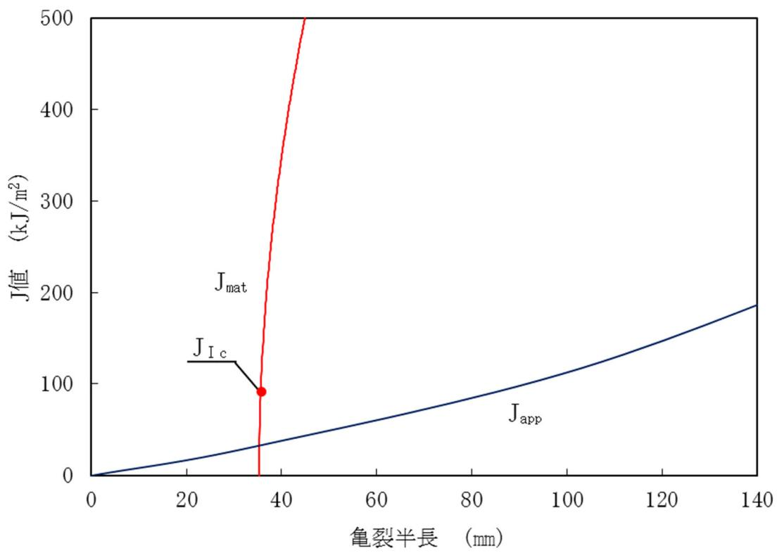
図9 RV入口  $32^\circ$  エルボの亀裂安定性評価線図
