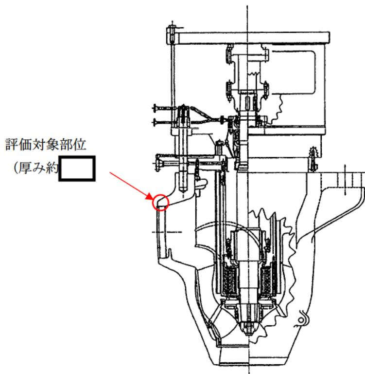
図2 1次冷却材ポンプケーシング
