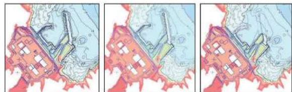
1) 沈下なし, 防波堤あり 2) 沈下1m, 防波堤あり 3) 沈下なし, 防波堤なし
