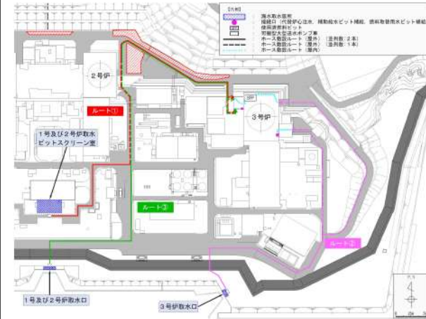
第1図 ホース敷設ルート
