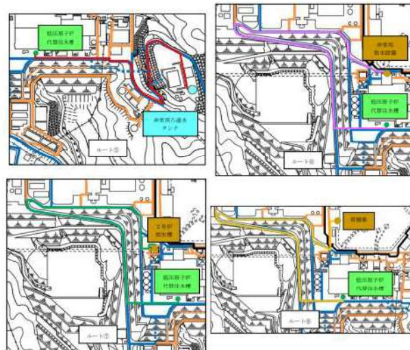
第4図 ホース敷設ルート（低圧原子炉代替注水槽への補給）（2/3）
