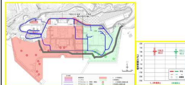
第5-5図 埋戻土の相対密度調査位置及び調査結果
