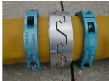
可搬型ホース（150A）接続後
