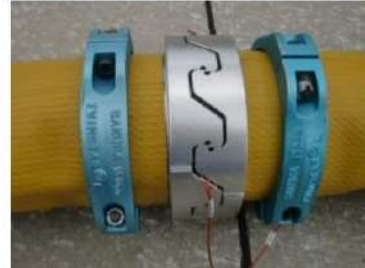
可搬型ホース (150A) 接続後
