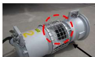
①水中ポンプの吸込み部
