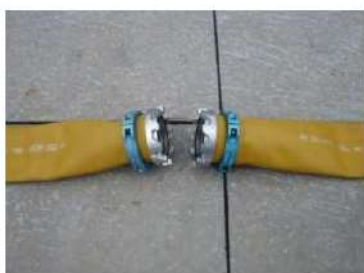
可搬型ホース（150A）接続前
