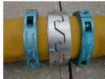
可搬型ホース（150A）接続後
