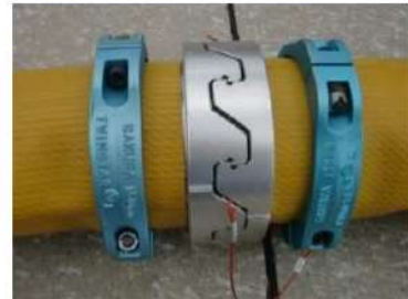
可搬型ホース（150A）接続後
