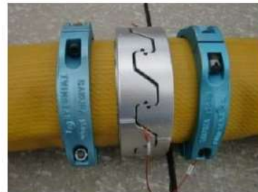
可搬型ホース（150A）接続後
