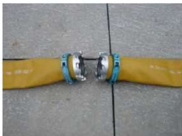
可搬型ホース（150A）接続前
