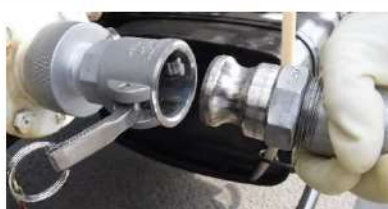
可搬型タンクローリーへのホース接続(継手接続式) (屋外)
