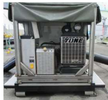
泡混合設備設置 (屋外)
