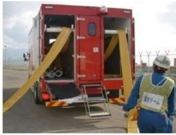
ホース延長・回収車（送水車用）による 可搬型ホース敷設 （屋外）
