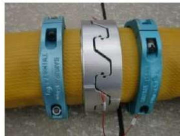
可搬型ホース(150A)接続後
