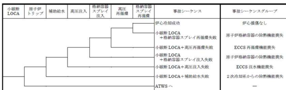
第 3.1.1.d-1(c) 図 小破断 LOCA イベントツリー
