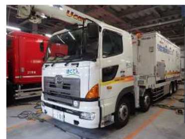
可搬型大容量 海水送水ポンプ車
