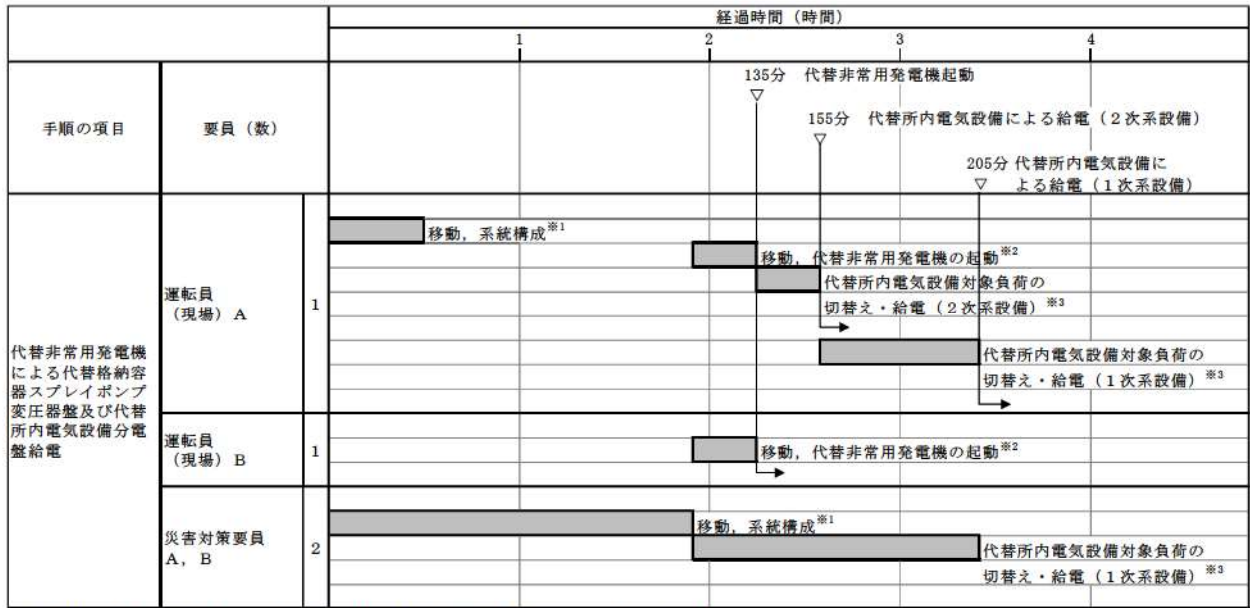
図2 代替所内電気設備による交流の給電 (代替非常用発電機) タイムチャート
