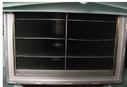
装置底部 (PAR 入口給気口)
