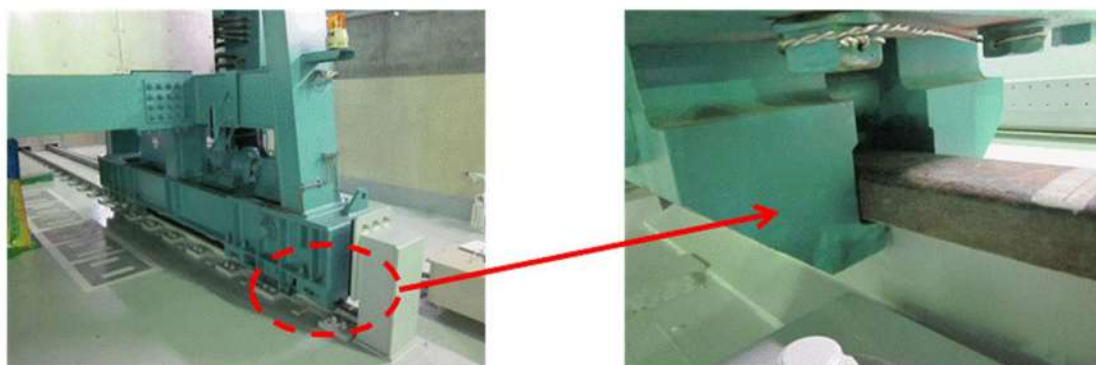
図 5.2.5 転倒防止金具の概要図
