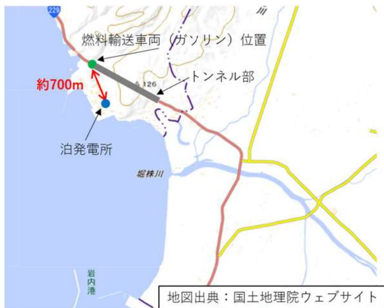
第 4-1 図 タンクローリー火災想定位置と発電用原子炉施設との位置関係
