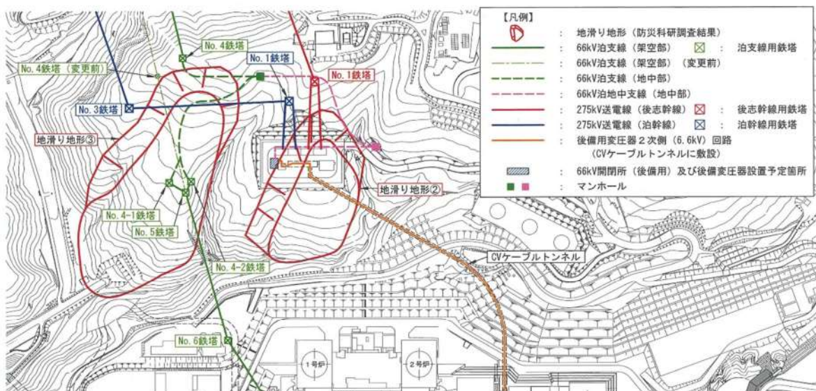
第 3.3 図 泊発電所周辺の地滑り地形及び対象施設（安全施設）位置図
