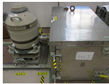
放射能測定器 ( \gamma 線スペクトロメータ)
