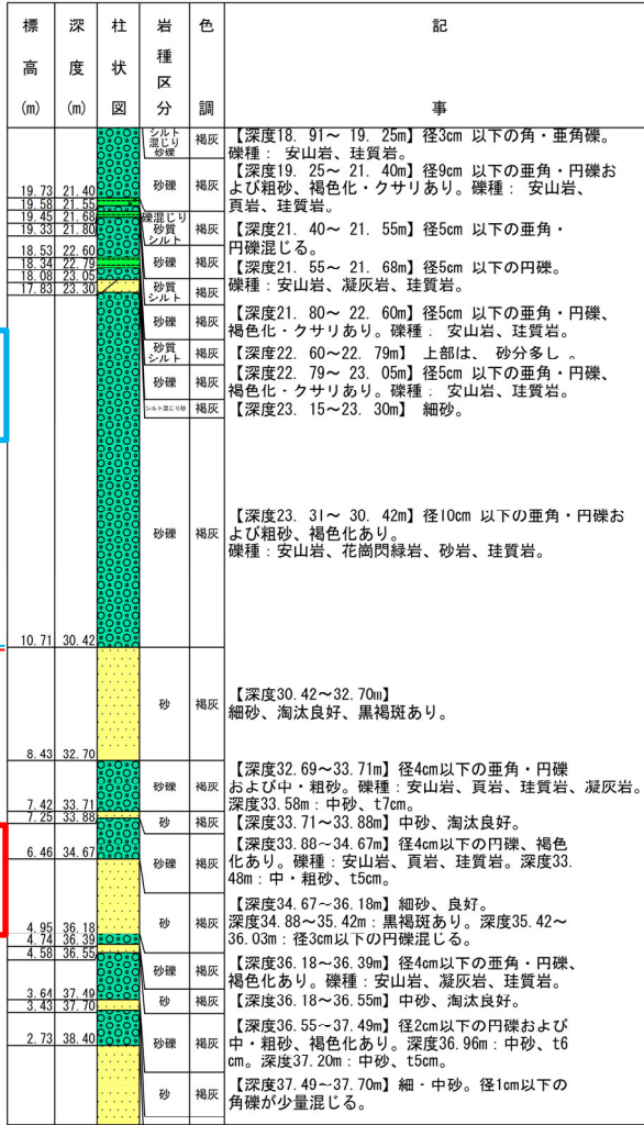
ボーリング柱状図(深度20~40m)
