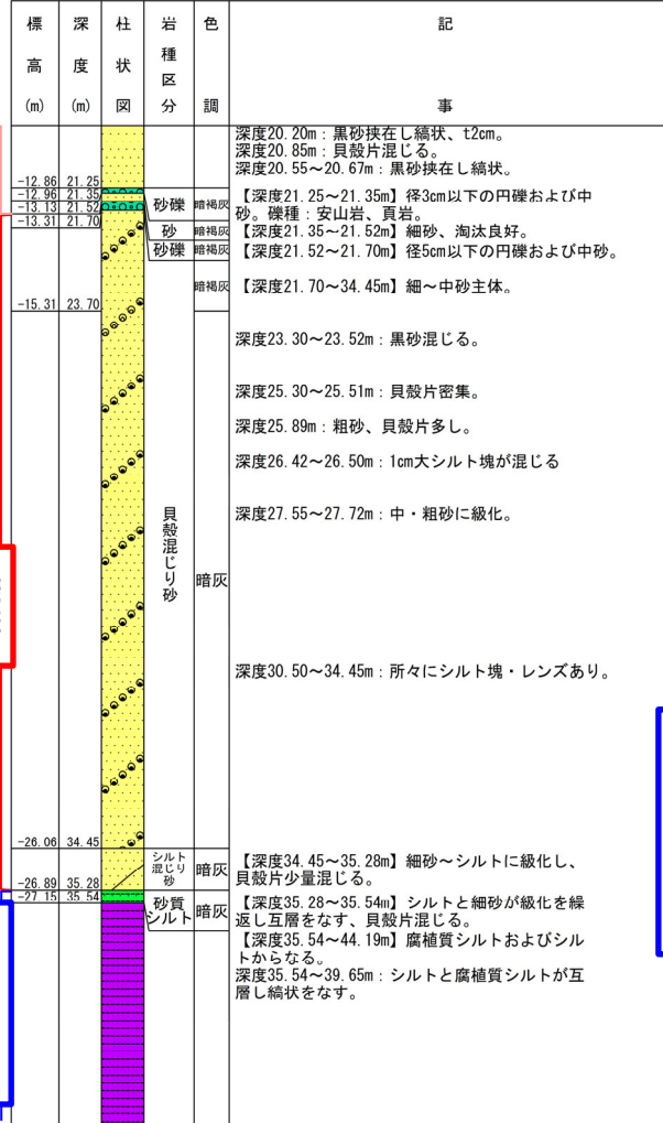
ボーリング柱状図(深度20~40m)
