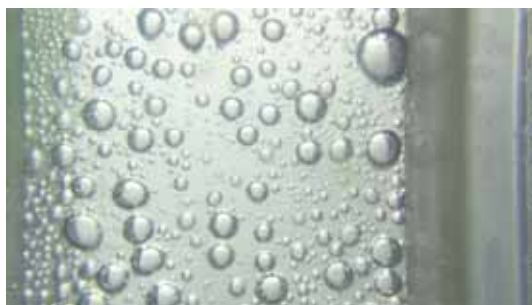
図 2-24 ONB 条件の近くで観測された気泡の発泡核付着 ( G = 300 \text{ kg/m}^2\text{s} , \Delta T_{\text{sub}} = 81 \text{ K} )
