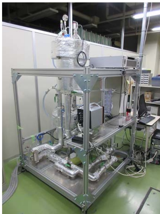
図 2-1 沸騰ループの全景
