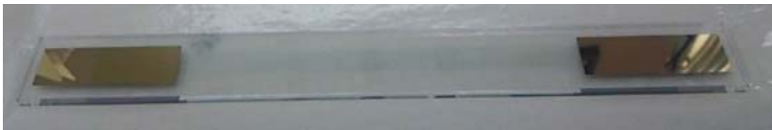
図 2-6 透明ヒーターの構成と写真
