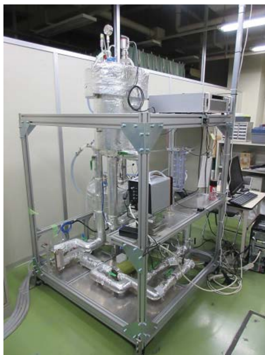
図 2-1 沸騰ループの全景
