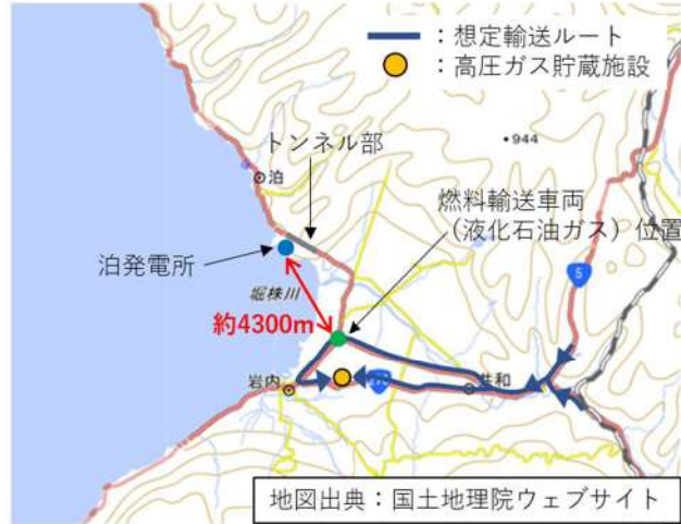
第 2. 2. 2. 3-2 図 高圧ガス輸送車両火災想定位置と発電用原子炉施設との位置関係
