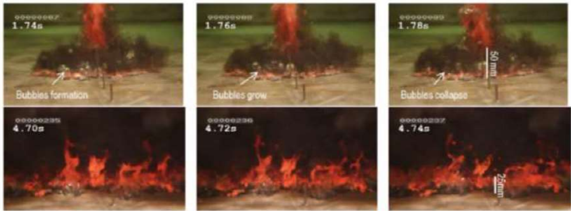
図 3.1-55 PULiMS-E4 試験での溶融物拡がり挙動
