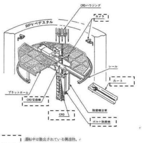
図2 格納容器下部内構造物（CRD自動交換機）の概要図
