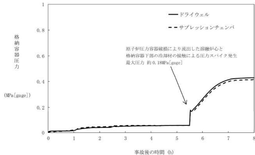
図4 格納容器圧力の推移（感度解析）
