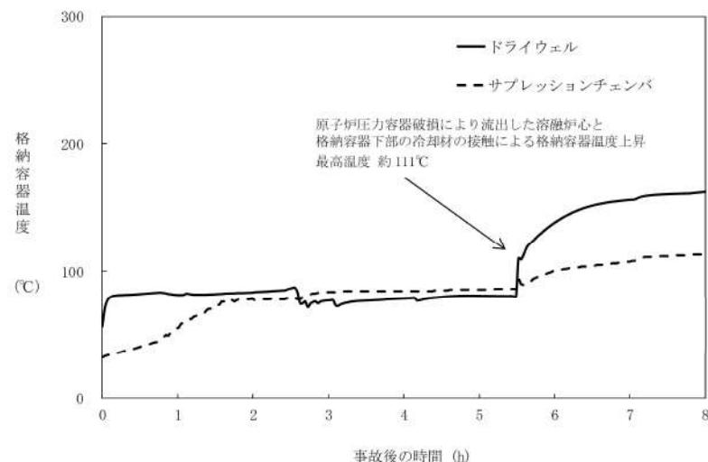
図5 格納容器温度の推移（感度解析）
