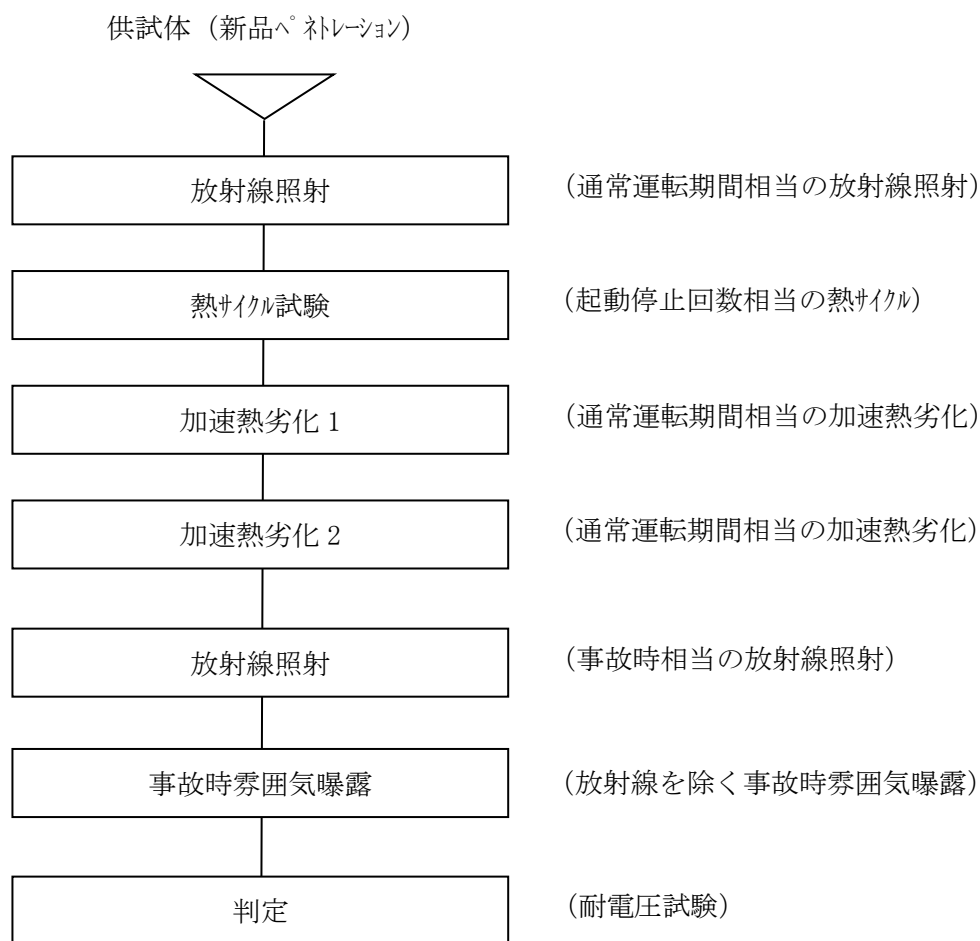
図3 モジュール型核計装用電気ペネトレーションの長期健全性試験手順
