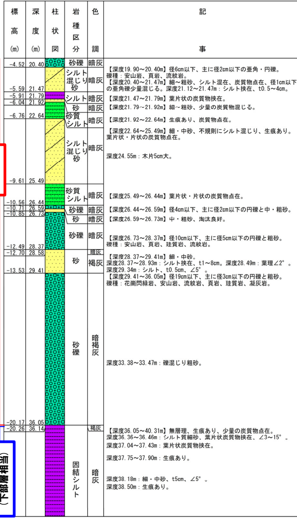
ボーリング柱状図 (深度20~40m)
