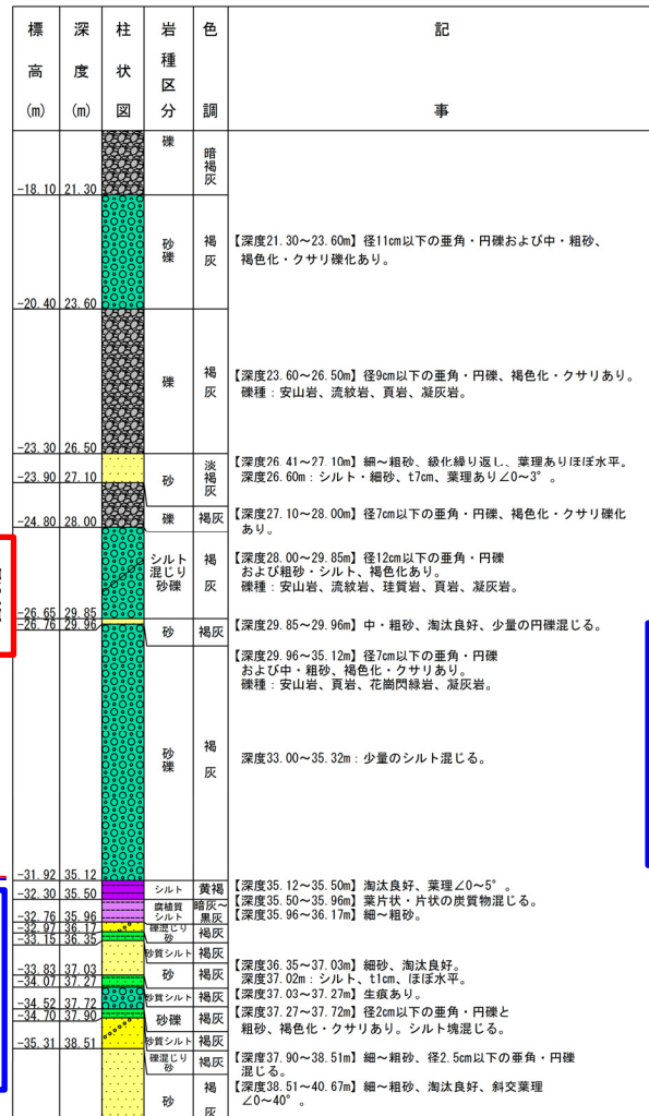
ボーリング柱状図 (深度20~40m)
