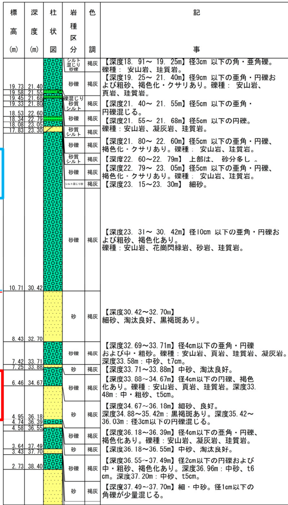
ボーリング柱状図(深度20~40m)
