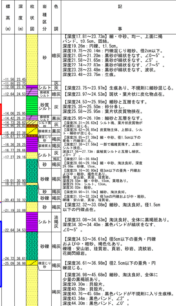
ボーリング柱状図(深度20~40m)
