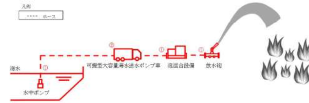
図 55-4-3 放水設備（泡消火設備）による航空機燃料火災への泡消火
