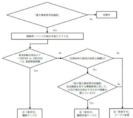
第1図：難燃性ケーブル確認方法
