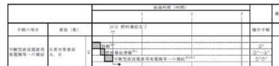
図 2.14.35 可搬型タンクローリーによる可搬型直流電源用発電機への燃料補給のタイムチャート*
