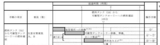
図 2.14.33 ディーゼル発電機燃料油貯油槽から可搬型タンクローリーへの燃料補給のタイムチャート（ホース使用時）*
