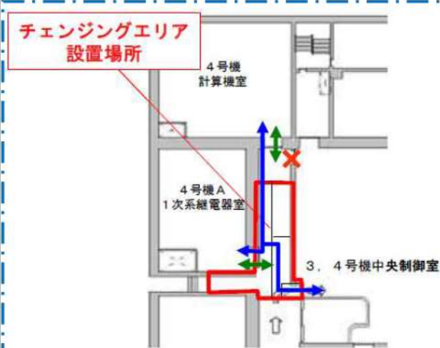
図32 チェンジングエリアに隣接する部屋への入退室手順
