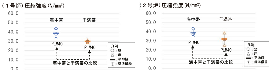
図6 取水構造物(海中帯・干満帯)の強度試験比較結果
